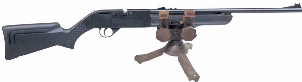
Мал. 13. Гвинтівка, закріплена у прицільному верстаті ПС-51
