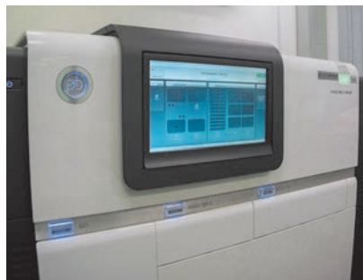
Мал. 28.1. Секвенатор — прилад для здійснення секвенування ДНК
