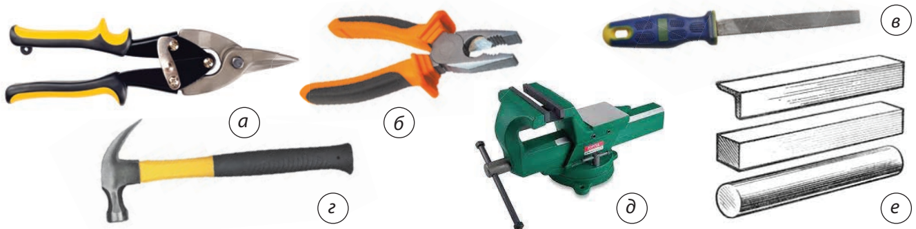
Мал. 15.3. Інструменти та пристосування, необхідні для виготовлення виробів із тонколистового металу : а — ножиці по металу; б — плоскогубці; в — напилек із мілкою насічкою; г — молоток; д — слюсарні лецата; е — оправка
