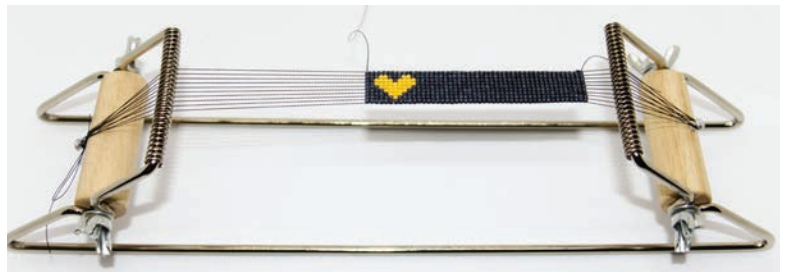
Мал. 11.13. Варіант верстата для ткання бісером
