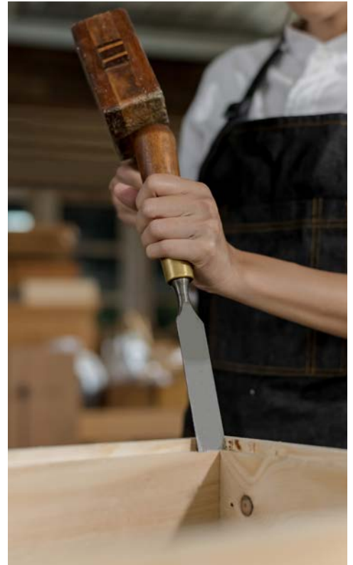
Мал. 18.10. Процес заглиблення долота
