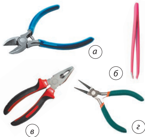
Мал. 11.7. Інструменти для виготовлення виробів із бісеру: а — кусачки; б — пінцет; в — плоскогубці; г — круглогубці
