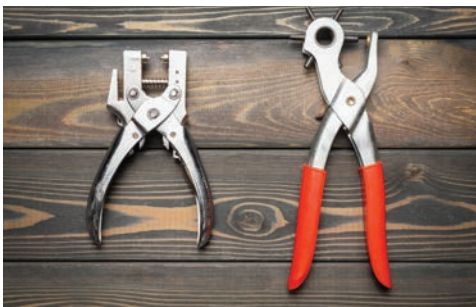
Мал. 15.12. Інструменти та пристосування для заклепкових з'єднань
