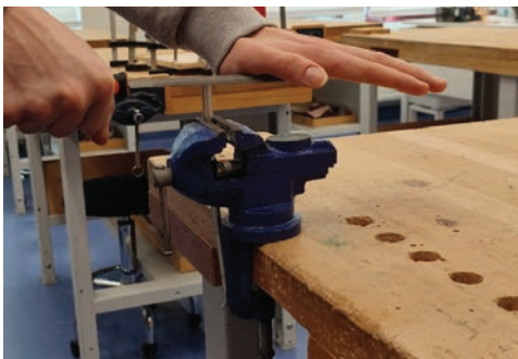
Мал. 15.9. Положення рук під час обпилювання
